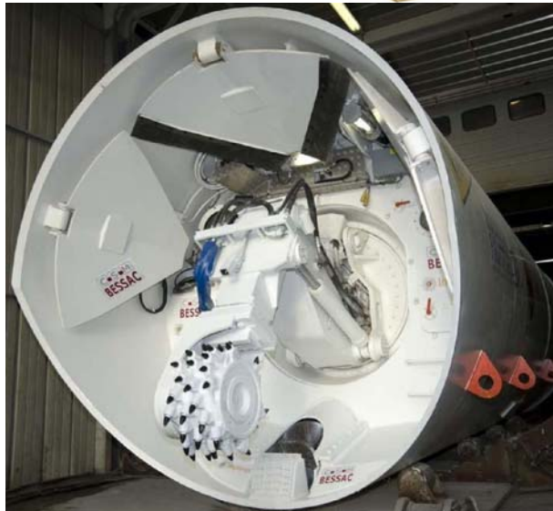
Figure 10 : Vue éclatée et tête du tunnelier
