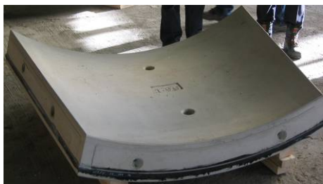
Figure 11 : Vue d'un voussoir en usine
