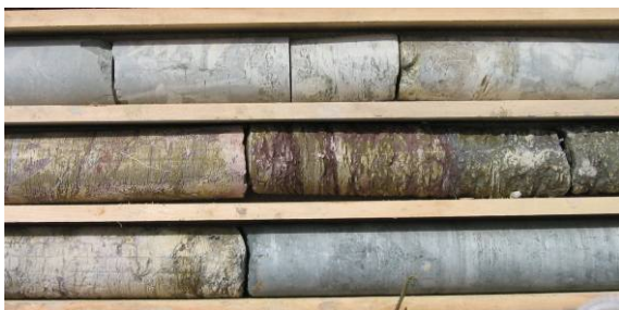
Figure 8 : Différents faciès de molasse en sondage
