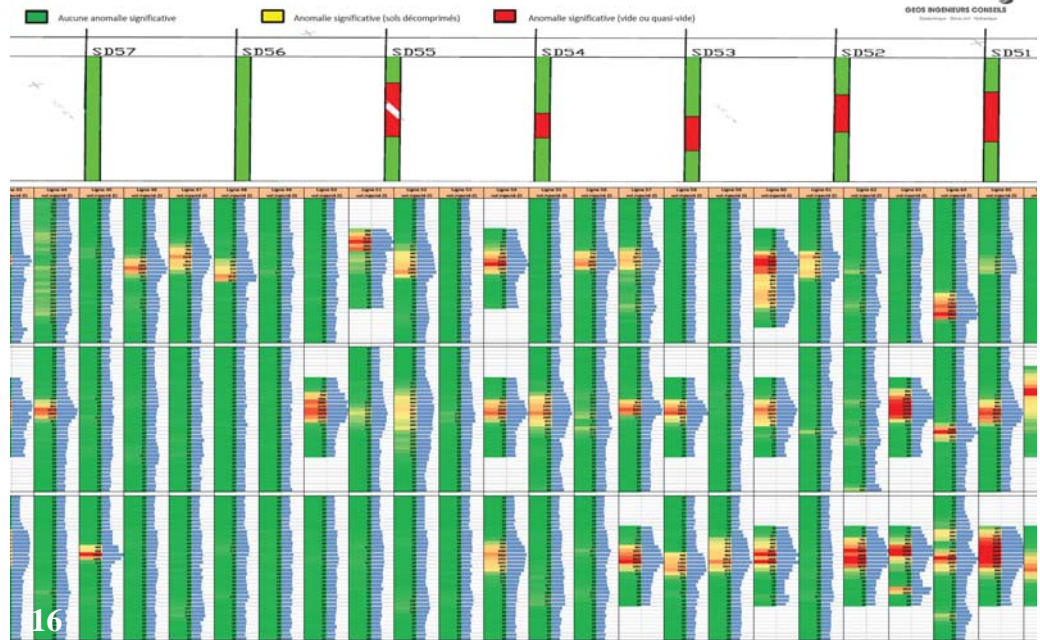
16 - Extrait du profil en long des lignes d'injection
