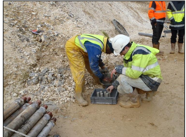
Figure 5b. Prélèvements d'éprouvettes de spoils pour mesures de Rc
