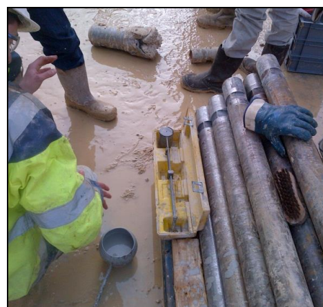
Figure 7b. Contrôle de densité des spoils à la balance baroïde
