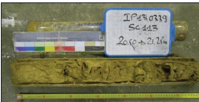
Figure 2a. Carotte des argiles de remplissage de l'anomalie karstique
