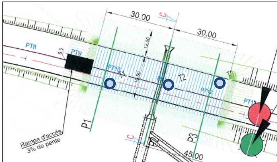
Figure 4. Vue en plan du remblai d'essai.
